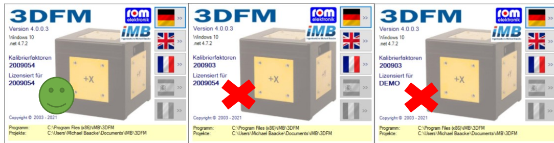
Abbildung 12 Kontrolle Seriennummer Messgerät und Kalibrierdatei
